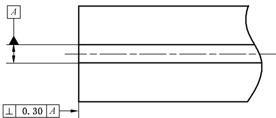
图 6 底面端边对导向面中心线垂直度
